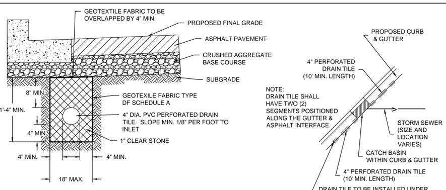
**CURB INLET WITHIN CURB & GUTTER**
