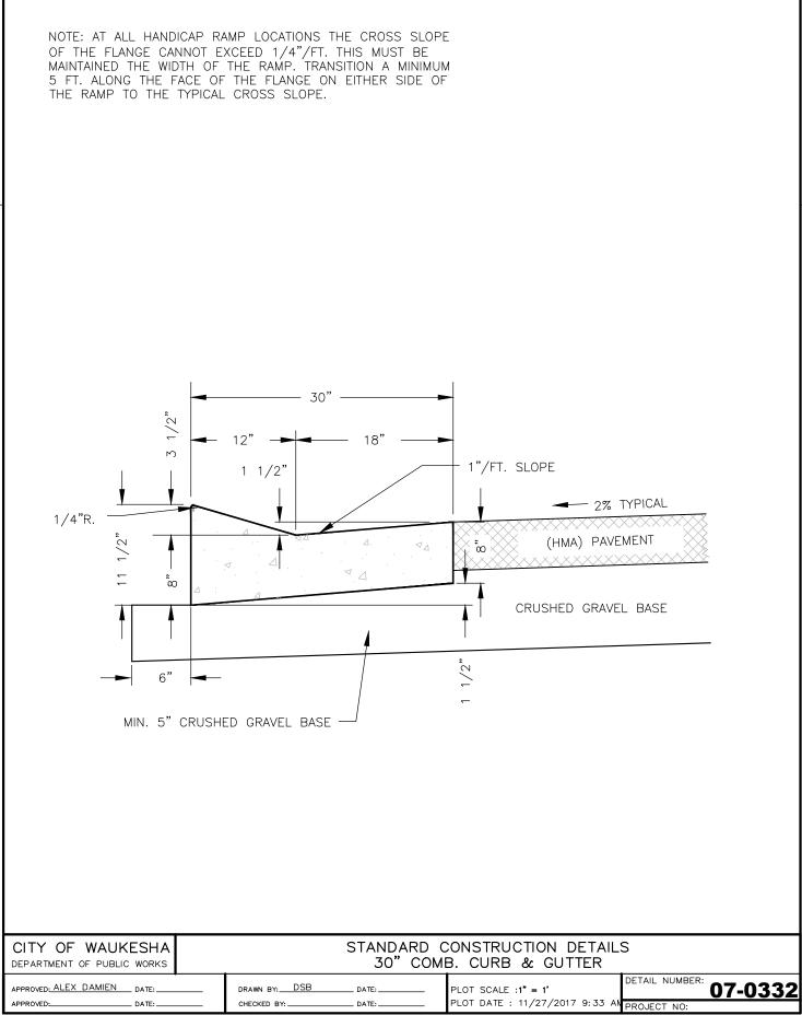
NOTE: AT ALL HANDICAP RAMP LOCATIONS THE CROSS SLOPE OF THE FLANGE CANNOT EXCEED 1/4"/FT. THIS MUST BE MAINTAINED THE WIDTH OF THE RAMP. TRANSITION A MINIMUM 5 FT. ALONG THE FACE OF THE FLANGE ON EITHER SIDE OF THE RAMP TO THE TYPICAL CROSS SLOPE.
